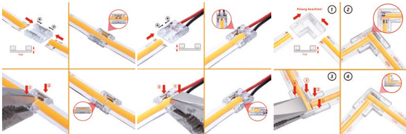
Zpracování drátěných spojů
