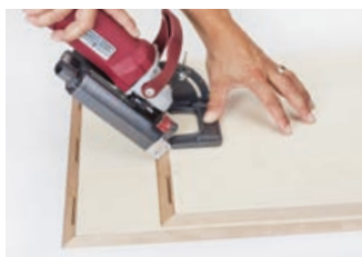
1. Frézování drážek do obrobku
