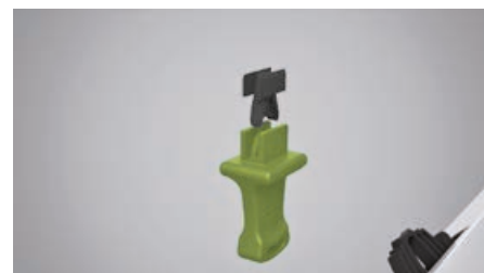
3. předpínací klip nasadit na vkládací klip
